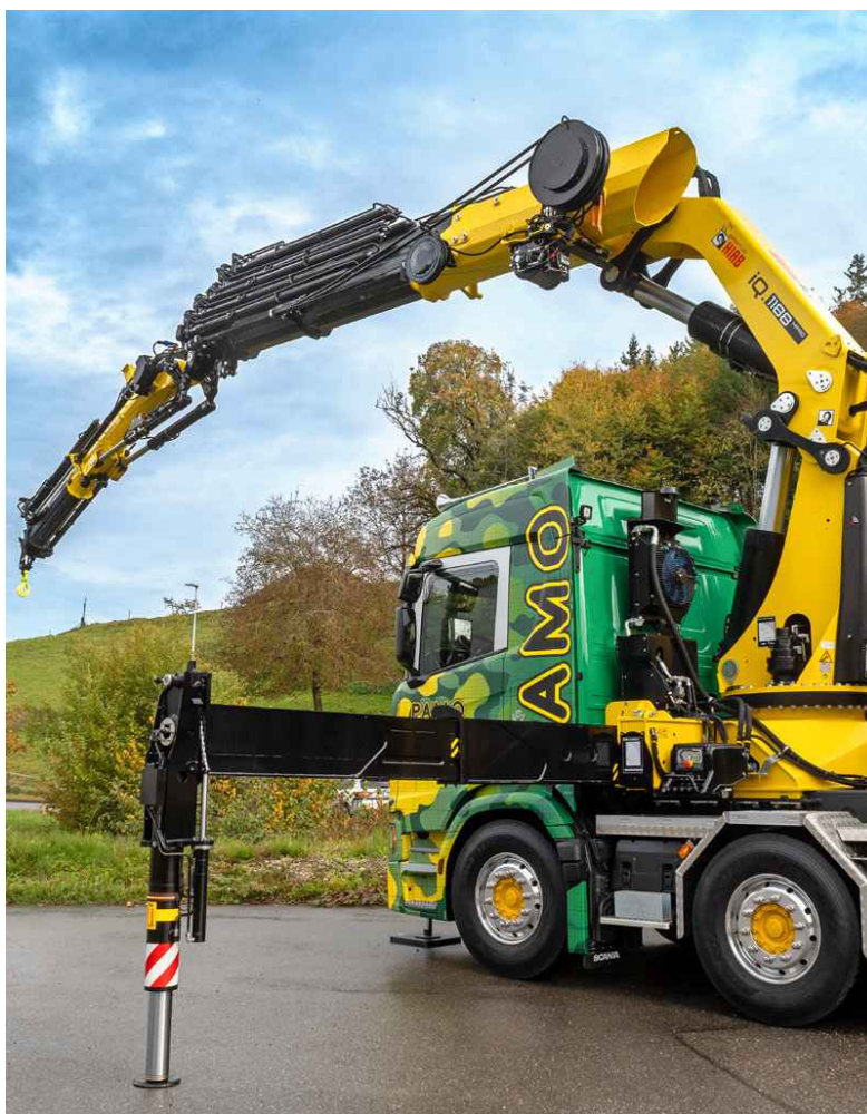
Der 120-tm-Kran ist stark, aber trotzdem kompakt.
