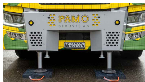
Ce Scania est également équipé de stabilisateurs à l'avant.
