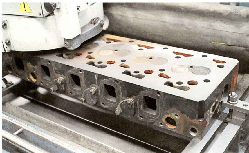
Planschleifen und Fräsen von Zylinderköpfen bietet Derendinger als Dienstleistung ebenfalls an. Fotos: Derendinger
