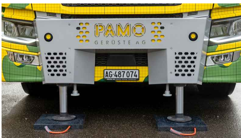
Der Scania ist auch mit Frontstützen ausgerüstet.
